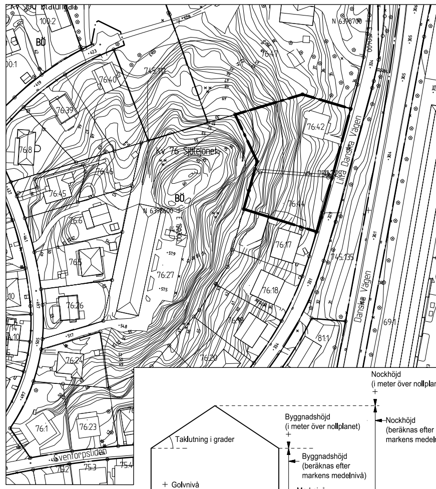
GRUNDKARTA Principskiss över hur höjder och taklutning beräknas.
